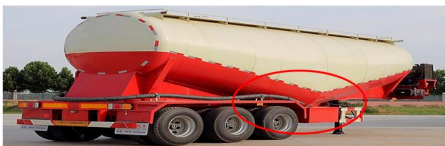
Figura 2. Forma cónica en el centro de la cisterna. Fuente: CBCM
