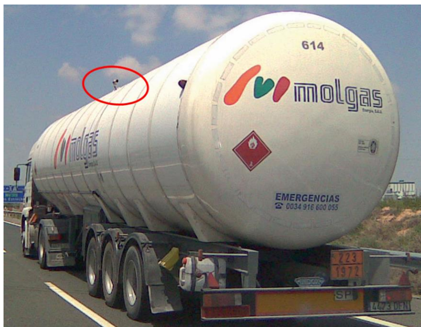
Figura 7. Válvula de sobrepresión en cisterna de GNL. Fuente: CBCM
