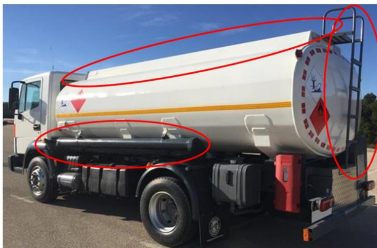
Figura 3. Escaleras, tubos de carga y cubetos en cisternas que transportan líquidos. Fuente: CBCM
