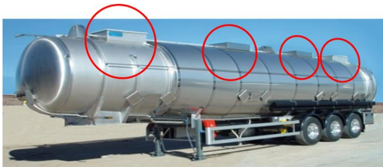
Figura 4. Bocas de hombre en cisternas de líquidos. Fuente: CBCM
