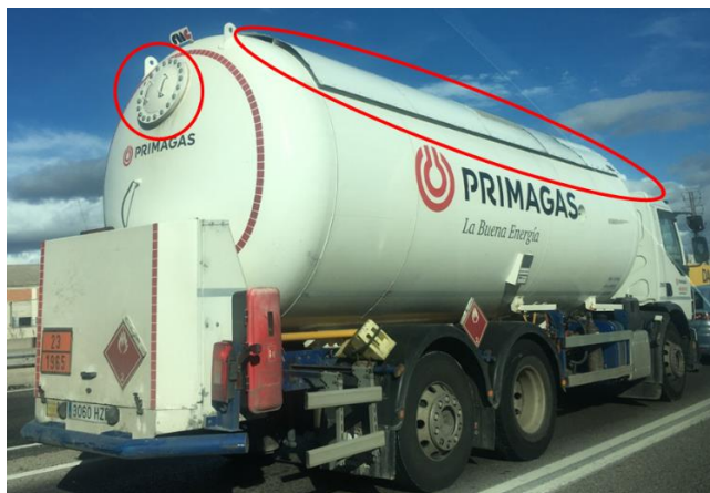
Figura 5. Paraisol y galga rotativa en una cisterna de gases licuados. Fuente: CBCM
